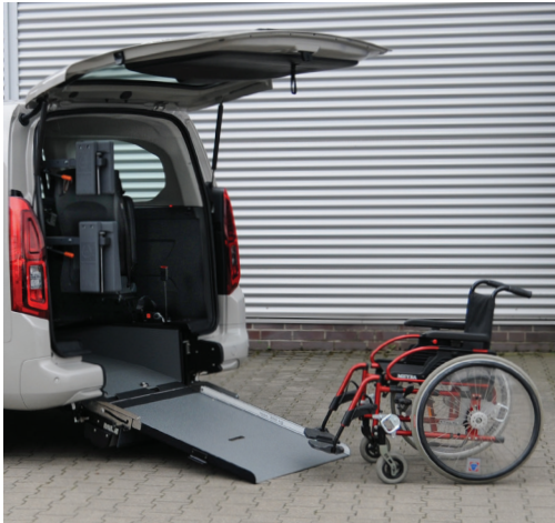
Bei ausgeklappter Rampe lässt sich das Fahrzeug bequem mit dem Rollstuhl befahren.
